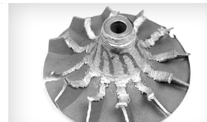
Panne d'une roue compresseur
