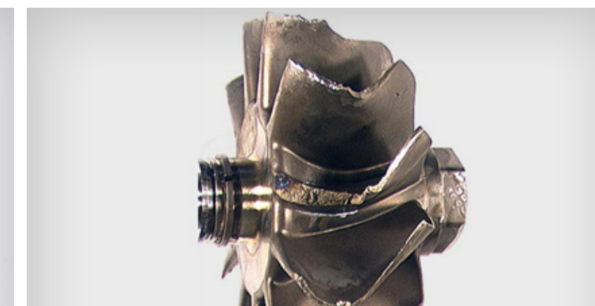
Rupture par fatigue de la roue de turbine en raison d'une vitesse cyclique trop élevée
