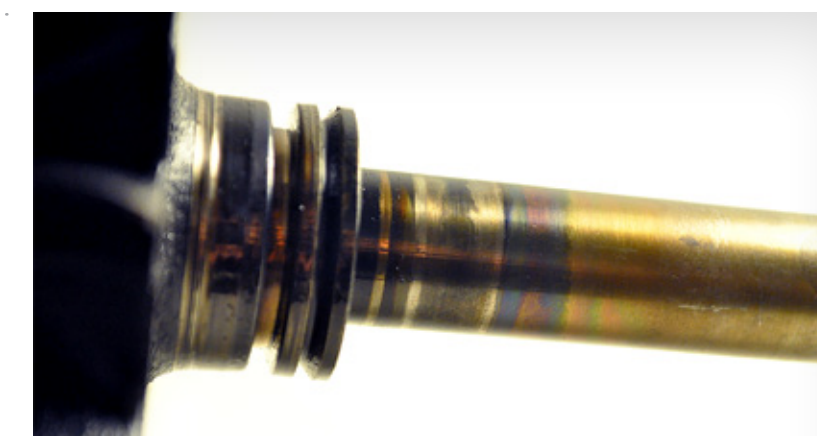
Température élevée et transfert de matériaux vers le système de roulement
